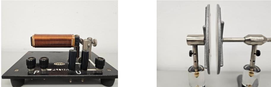
Abbildung 8.2: Reale Induktivität (Spule, links) und Kapazitäten (Kondensator, rechts)
