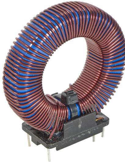
Abbildung 6.12: **Foto einer Ringkernspule.** Die ringförmige Bauweise bringt die Besonderheit mit sich, dass sich der magnetische Fluss vor allem innerhalb des Kerns bewegt, wodurch magnetische Störfelder reduziert werden.
