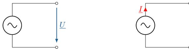
Abbildung 7.18: **Quellen von Wechselgrößen.** Ideale Wechselspannungsquelle und ideale Wechselstromquelle.
