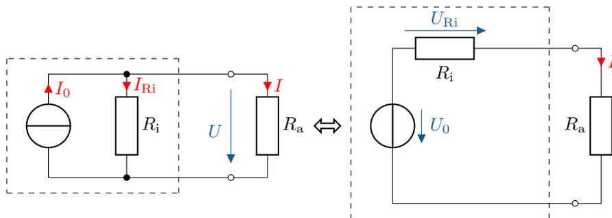
Abbildung 4.17: Umwandlung einer Ersatzstromquelle (links) in eine Ersatzspannungsquelle (rechts) und umgekehrt
