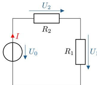
Abbildung 4.1: Reihenschaltung von zwei Widerständen und einer Spannungsquelle
