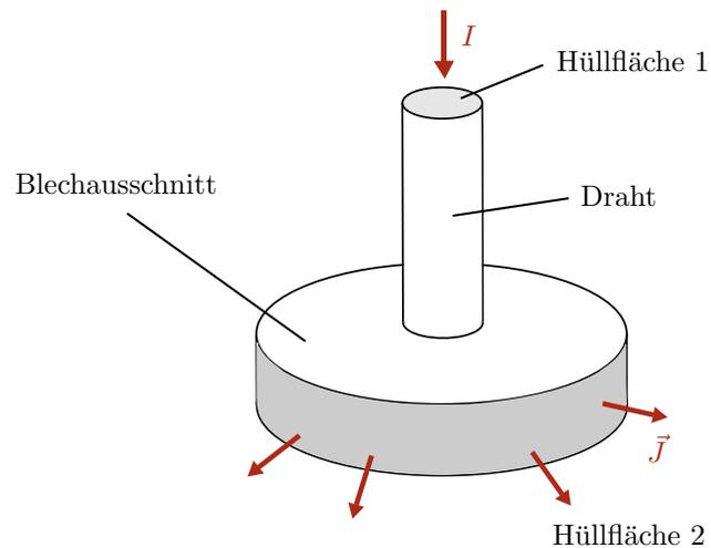
Abbildung 3.3: An einen Blechausschnitt angeschlossener Draht. Die Stromstärke  $I$  fließt in den Draht hinein, während eine Stromdichte  $\vec{J}$  aus dem Blechausschnitt herausfließt.
