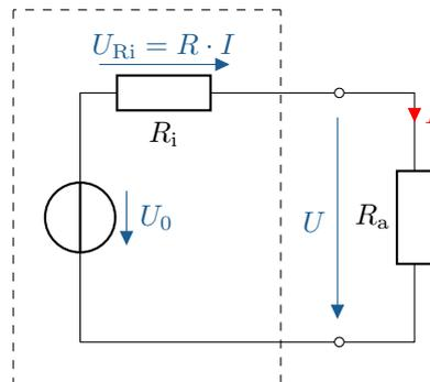
Abbildung 4.10: Die Ersatzspannungsquelle (gestrichelter Kasten) verfügt über das gleiche Ersatzschaltbild wie eine reale Spannungsquelle
