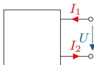
Abbildung 2.1: Allgemeine Darstellung eines Zweipols mit den gleich großen Stromstärken  $I_1$  und  $I_2$  sowie der anliegenden Spannung  $U$
