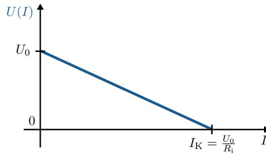
Abbildung 4.11: Die an den Klemmen der Ersatzspannungsquelle anliegende Spannung  $U$  in Abhängigkeit von der resultierenden Stromstärke  $I$
