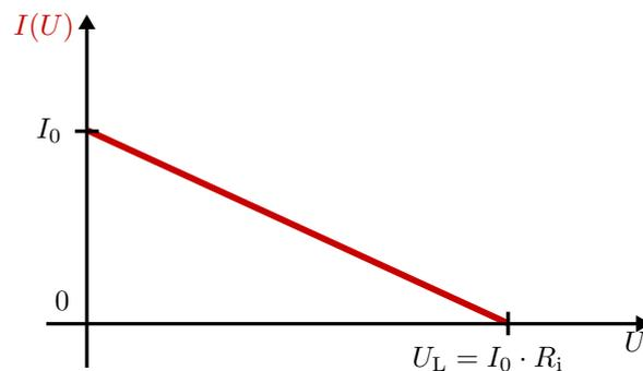
Abbildung 4.16: Die aus der Ersatzstromquelle herausfließende Stromstärke  $I$  in Abhängigkeit der sich einstellenden Spannung  $U$
