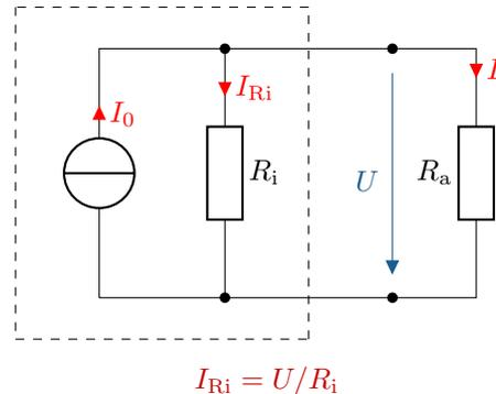
Abbildung 4.15: Die Ersatzstromquelle (gestrichelter Kasten) verfügt über das gleiche Ersatzschaltbild wie eine reale Stromquelle
