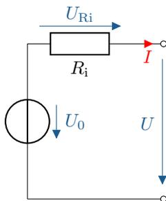
Abbildung 4.8: Aus einer idealen Spannungsquelle  $U_0$  und einem Innenwiderstand  $R_i$  bestehende reale Spannungsquelle
