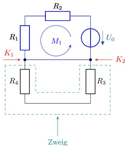
Abbildung 2.2: Der elektrische Grundstromkreis mit eingezeichneten Zweigen, Knoten und Maschen
