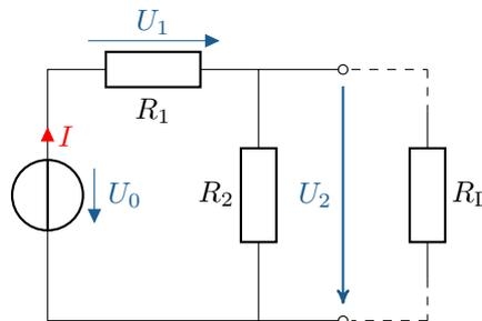
Abbildung 4.6: Mit dem Widerstand  $R_L$  belasteter Spannungsteiler
