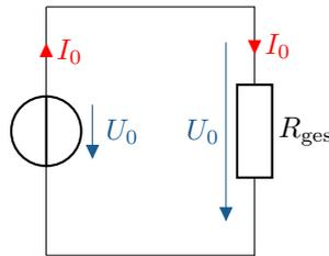
Abbildung 4.4: Zusammenfassung der parallel geschalteten Widerstände  $R_1$  und  $R_2$  aus Abbildung 4.3 zu  $R_{\text{ges}}$
