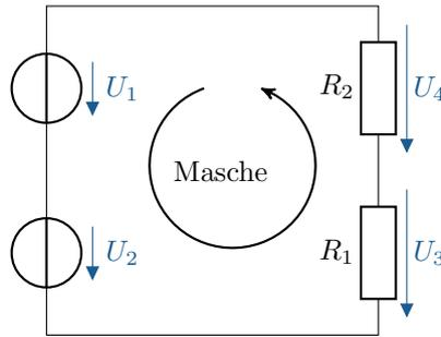
Abbildung 3.4: Beispielnetzwerk bestehend aus zwei Spannungsquellen und zwei Widerständen
