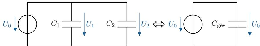
Abbildung 5.1: Zusammenfassen von zwei parallel geschalteten Kapazitäten  $C_1$  und  $C_2$  zu einer Gesamtkapazität  $C_{\text{ges}}$
