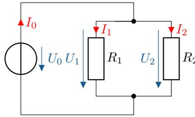
Abbildung 4.3: Parallelschaltung von zwei Widerständen und einer Spannungsquelle
