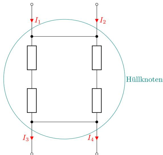
Abbildung 3.2: Hüllknoten einer elektrischen Schaltung
