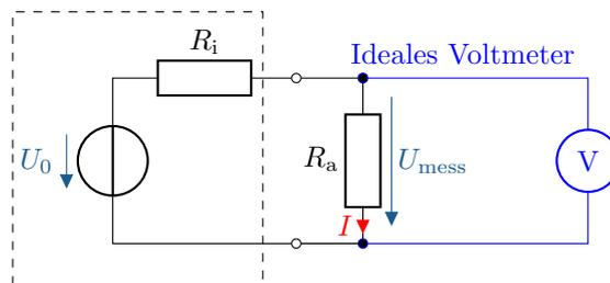
Abbildung 6.1: Eine reale Spannungsquelle (Kasten links) speist einen Lastwiderstand  $R_a$ . Die darüber abfallende Spannung wird mit einem idealen Voltmeter (blau) gemessen
