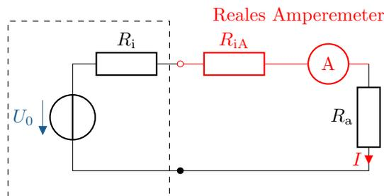
Abbildung 6.4: Messung der Stromstärke  $I$  durch einen Lastwiderstand  $R_a$  durch ein reales Amperemeter mit Innenwiderstand  $R_{iA}$  (rot)
