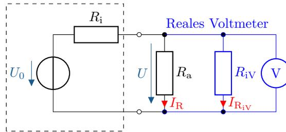
Abbildung 6.2: Messung der Spannung  $U$  über einem Lastwiderstand  $R_a$  durch ein reales Voltmeter mit endlichem Innenwiderstand  $R_{iV}$
