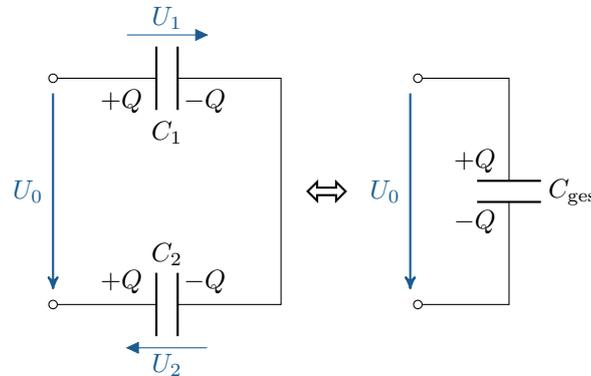
Abbildung 5.3: Spannungsteiler an einer Reihenschaltung von zwei Kapazitäten (links) sowie Ersatzschaltbild nach Zusammenfassen der Kapazitäten zu  $C_{\text{ges}}$
