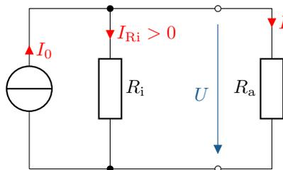
Abbildung 4.14: Aus einer idealen Stromquelle  $I_0$  und einem Innenwiderstand  $R_i$  bestehende reale Stromquelle, welche mit einem Widerstand  $R_a$  belastet ist
