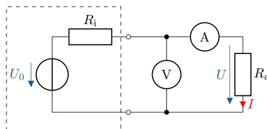
Abbildung 6.5: Stromrichtige Messschaltung zur Bestimmung der Stromstärke  $I$  sowie der Spannung  $U$  an einem Lastwiderstand  $R_a$
