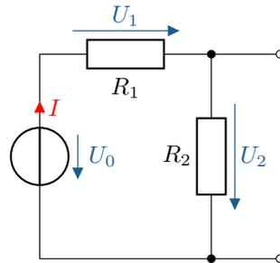
Abbildung 4.5: Unbelasteter Spannungsteiler
