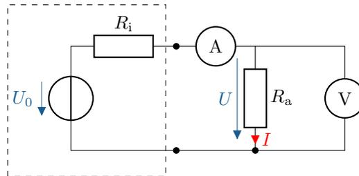
Abbildung 6.6: Stromrichtige Messschaltung zur Bestimmung der Stromstärke  $I$  sowie der Spannung  $U$  an einem Lastwiderstand  $R_a$
