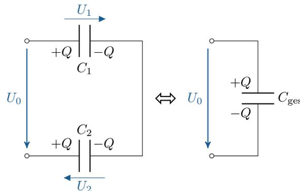
Abbildung 5.2: Zusammenfassen von zwei in Reihe geschalteten Kapazitäten  $C_1$  und  $C_2$  zu einer Gesamtkapazität  $C_{\text{ges}}$
