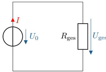
Abbildung 4.2: Zusammenfassen von  $R_1$  und  $R_2$  zu  $R_{\text{ges}}$
