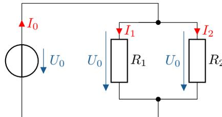
Abbildung 4.7: Stromteiler der Stromstärke  $I_0$  in die Teilstromstärken  $I_1$  und  $I_2$ , bestehend aus den parallel geschalteten Widerständen  $R_1$  und  $R_2$
