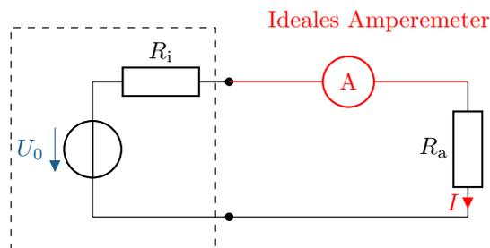
Abbildung 6.3: Eine reale Spannungsquelle (Kasten links) speist einen Lastwiderstand  $R_a$ . Der durch den Lastwiderstand fließende Strom  $I$  von einem idealen Amperemeter (rot) gemessen
