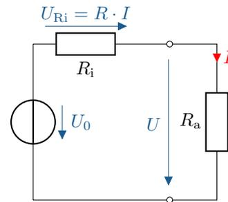
Abbildung 4.9: Mit einem Lastwiderstand  $R_a$  belastete reale Spannungsquelle
