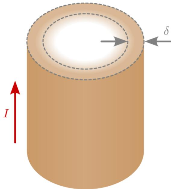
Wechselspannung nutzt nur die Oberfläche eines Leiters.
