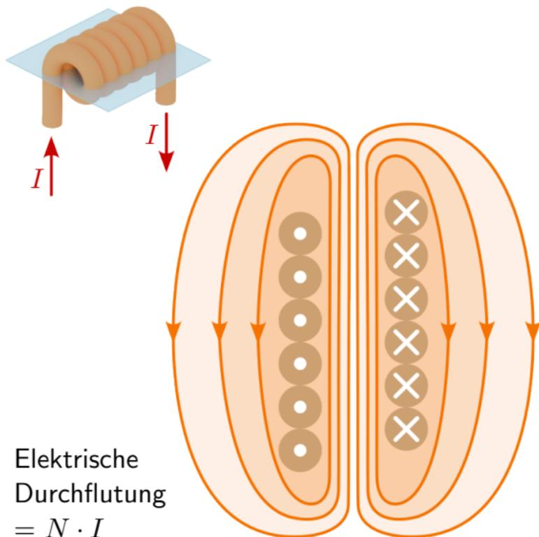
Durchflutung oder magnetische Spannung  $\Theta$  (Theta) = Gesamtstrom einer durchfluteten Fläche
