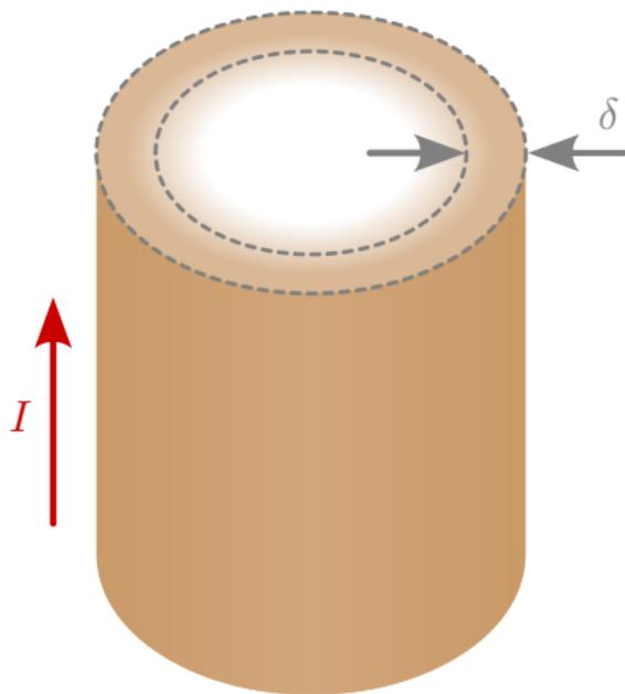
Wechselspannung nutzt nur die Oberfläche eines Leiters.
