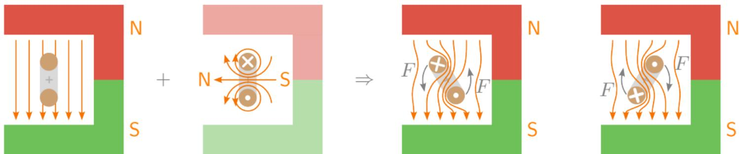
Ein Gleichstrommotor hat im Luftspalt eine magnetische Flussdichte von  $B = 0,8 \text{ T}$ . Unter den Polen befinden sich insgesamt  $N = 400$  Wicklungen, die mit einem Strom von  $I = 10 \text{ A}$  durchflossen werden. Die wirksame Leiterlänge ist  $\ell = 150 \text{ mm}$ . Berechnen Sie die Kraft  $F$  am Umfang des Ankers.
