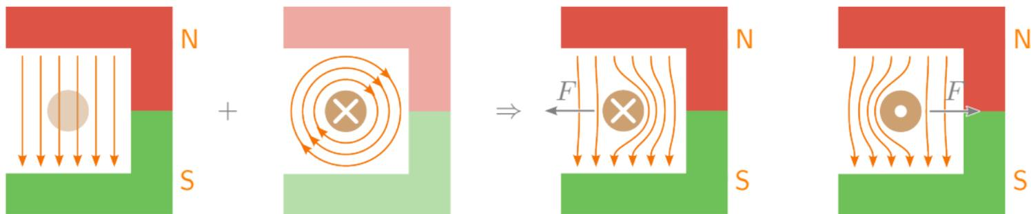
Auf eine mit der Geschwindigkeit  $\vec{v}$  bewegte Einheitsladung  $q$  im Magnetfeld  $\vec{B}$  wirkt eine Kraft:
