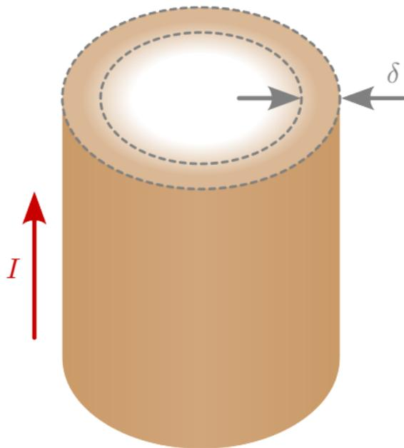
Wechselspannung nutzt nur die Oberfläche eines Leiters.
