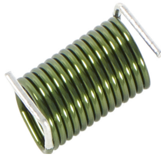
Abbildung 6.1: Luftspule aus Lackdraht. Luftspulen besitzen keinen magnetischen Kern und haben dadurch eine vergleichsweise geringere Induktivität als Spulen mit weichmagnetischem Kern.
