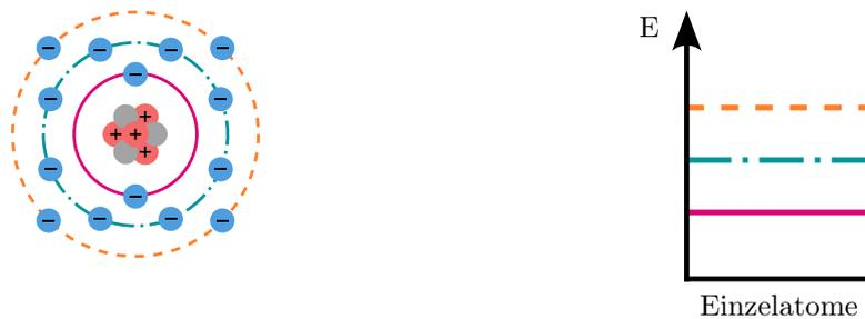
Abbildung 1.2: **Zusammenhang zwischen dem Bohrschen Atommodell und Bändermodell.** Darstellung des Zusammenhangs zwischen dem Abstand von Elektronen zum Kern und der Höhe des zugehörigen diskreten Energieniveaus. Links: Bohrsches Atommodell eines Si-Atoms. Rechts: Bändermodell eines Si-Atoms mit den möglichen Energieniveaus.
