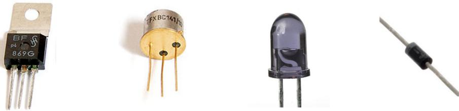
Abbildung 1.1: **Beispielfotos typischer Halbleiterbauelemente.** V.l.n.r.: Feldeffekttransistor, Bipolartransistor, Leuchtdiode, Diode.
